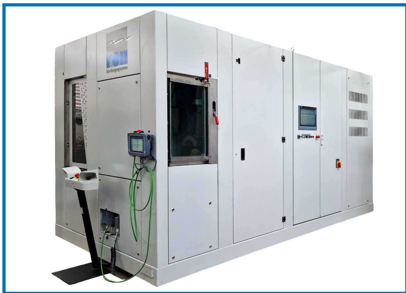
Installation d'ébavurage à jet d'eau haute pression
