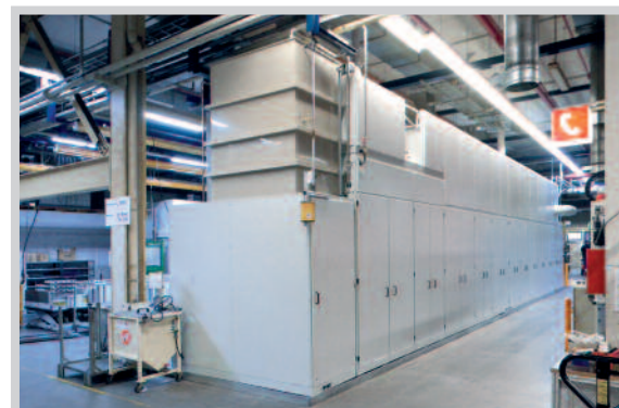
Installation d'immersion à plusieurs chambres avec chambre à solvant
