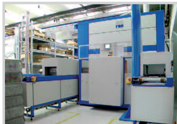
Installation mono-chambre avec dispositif de chargement automatisé
