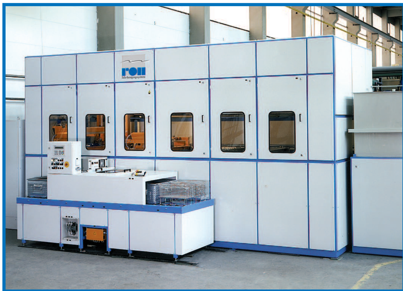
Installation à immersion à plusieurs cuves équipée de plusieurs porte-paniers
