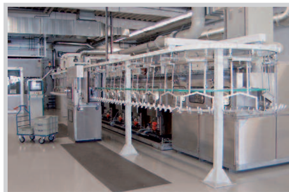
Installation à passage continu avec convoyeur suspendu
