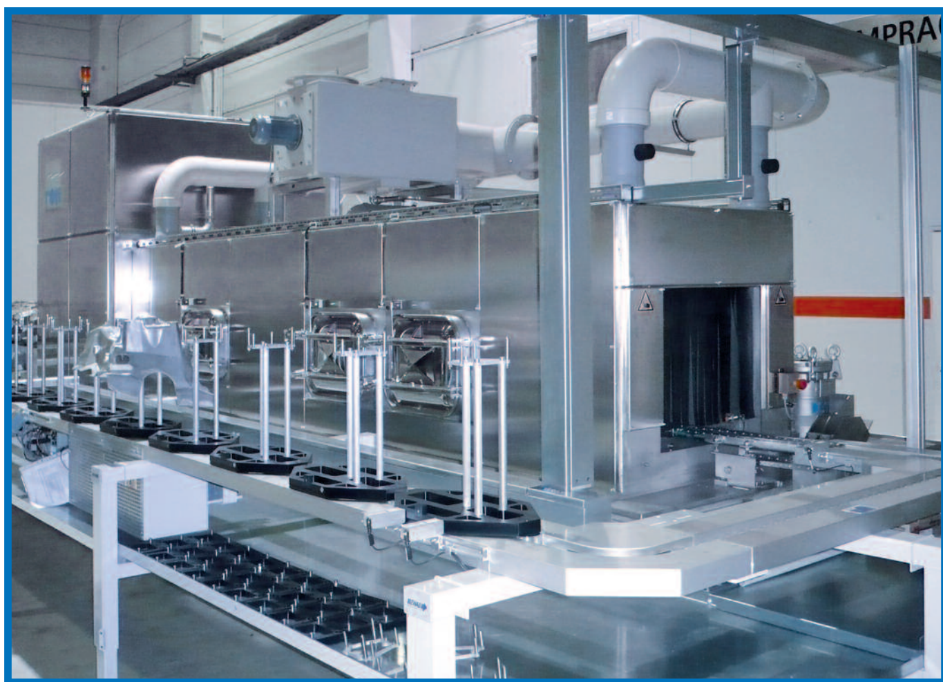
Installation à passage continu avec dispositif pour le transport des pièces
